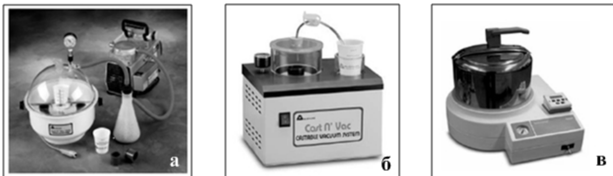
Рис. 2.11. Системи вакуумного просочування «Buehler»; а) серія «Cast n'Vac 1000», б) серія «Cast n'Vac», в) серія «Technomat»
