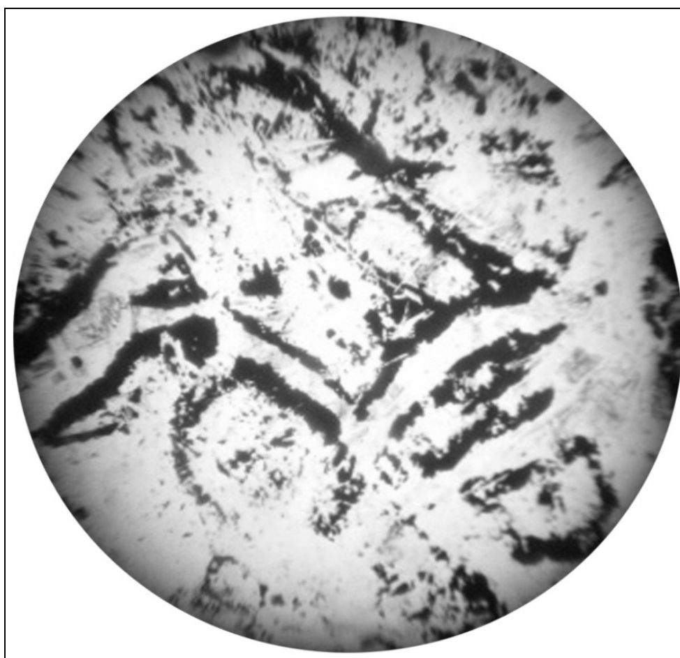
Рис. 5.13. Футляроподібна структура (різновид скелетної структури) зерен олівіну, заміщеного по контурах магнетитом при серпентинізації. Світло минаюче, ніколі ||, збільш. 90^{\times}
