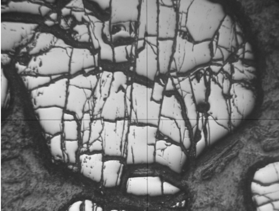
Рис. 5.22. Гранокластична структура дроблення зерен хроміту. Світло відбите, ніколі ||, збільш. 90^{\times}
