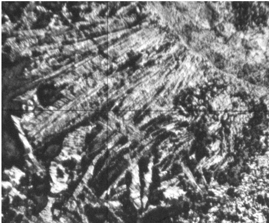
Рис. 5.8. Субграфічна структура (голчасті та мірмекітоподібні виділення фериту в технічному камені). Світло відбите, ніколи ||, збільш. 90 X
